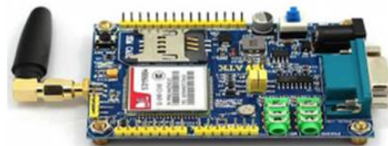
Fig 2 . SIM900 GSM Module
