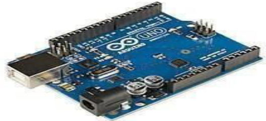
Figure 2 Arduino Uno R3
