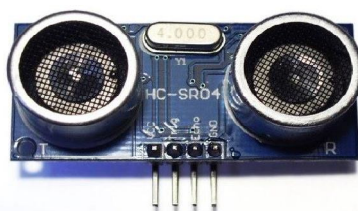
Fig. 3: Ultra Sonic Sensor(HC-SR04)
