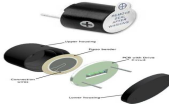
Fig. 5. Piezo Buzzer
