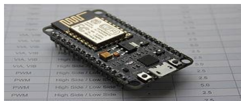
Fig.2. NodeMCU micro controller
