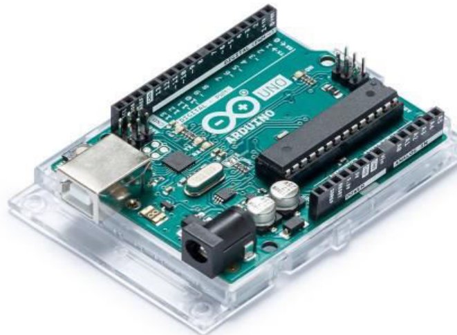
Fig: Arduino UNO
