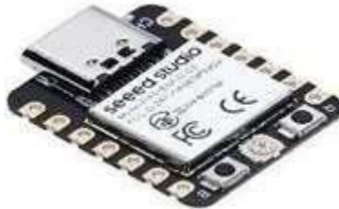
Fig. 6: ESP32-C3 WIFI Module
